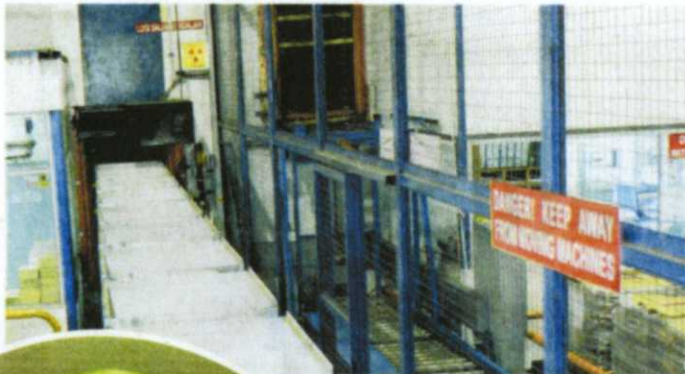
SISTEM konveyor membawa produk ke dalam bilik iradiasi. Pagar pula memisahkan kawasan produk yang belum dan telah diiradiasi.
